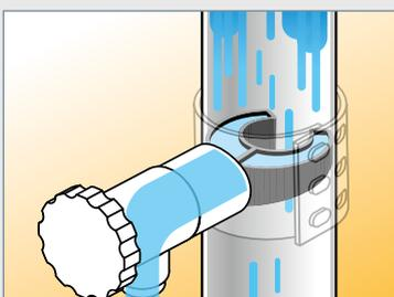
L'eau qui descend dans le conduit de la gouttière est centrifugée le long des parois et récupérée dans l'écope en caoutchouc.
