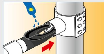
4) Lubrifier l'écope avec du savon liquide, la comprimer et l'introduire dans le conduit.
