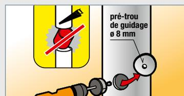
1) Percer la gouttière avec la scie-cloche fournie.
